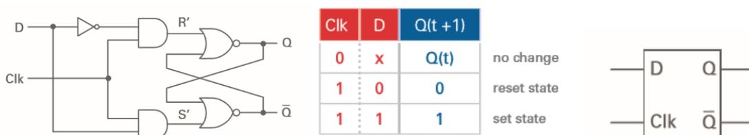
Рисунок 1-7 Схема D-триггера (слева), характеристическая таблица (в центре) и условное графическое обозначение (справа)
